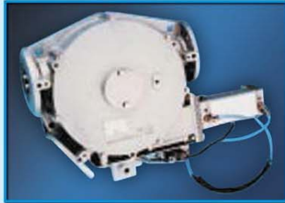
ไดเวอร์เตอร์วาล์ว Diverter Valve
