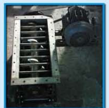
เครื่องย่อย ก้อนวัสดุให้มีขนาดเล็กลง Lump Breaker
