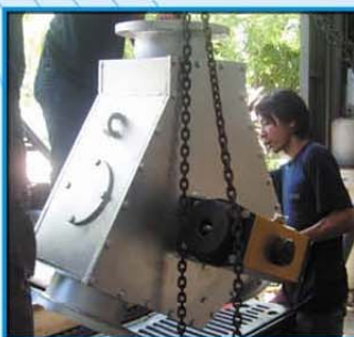
เครื่องย่อย ก้อนวัสดุให้มีขนาดเล็กลง Lump Breaker
