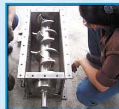
เครื่องย่อย ก้อนวัสดุให้มีขนาดเล็กลง Lump Breaker
